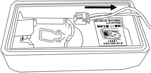
リミットスイッチ付きハーネスコネクタのコネクタ付近のケーブルをコネクタ嵌合部分が外れるように水平に引っ張りコネクタから抜いてください。
