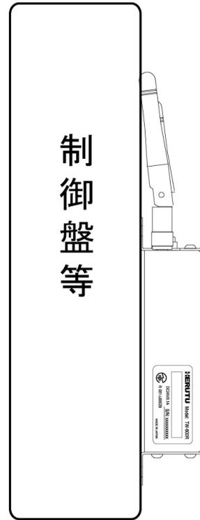
✕ アンテナが制御盤(金属物)に接触している
