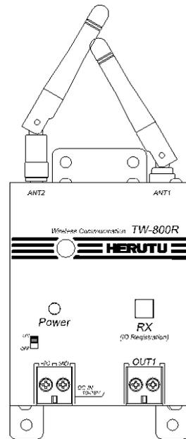
✕ アンテナ同士が接触している。
