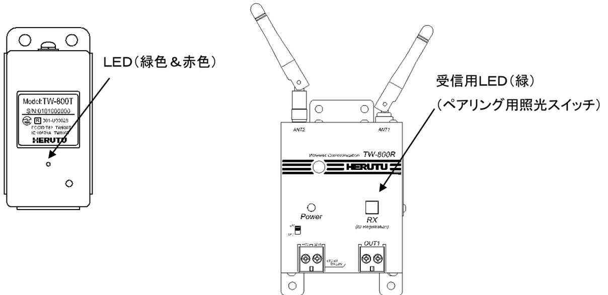
②ツールを使用した作業によりリミットスイッチが叩かれると送信機は信号を発信します。
