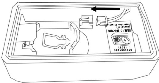
新しいリミットスイッチ付きハーネスコネクタのコネクタ部分を押ししてTW-800Tのコネクタに差し込んでください。カチッと音がするまでしっかりと押し込んで下さい。押し込む際には爪の先等で白いコネクタ部分を押ししてください。また、コネクタの方向が合っているか確認してから挿し込んでください。
