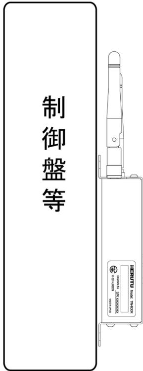
✕ 背面の制御盤(金属物)とアンテナが平行になっている
