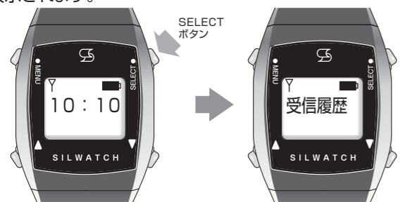
SELECTボタンを長押し(約2秒間)する 受信履歴画面が表示される
