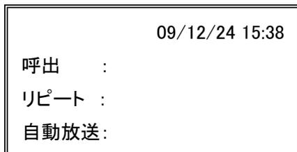
←解除の信号を受信すると送信機のIDが消去されます。同時に解除の音声メッセージがライン出力されます。
