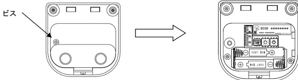
②内部の電池ケースに単四型乾電池を取り付けます。この時、電池の極性を間違えないようにして下さい。
