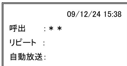
←送信機からの呼び出し信号を受信すると、送信機のIDを表示します。同時に呼び出しの音声メッセージがライン出力されます。
